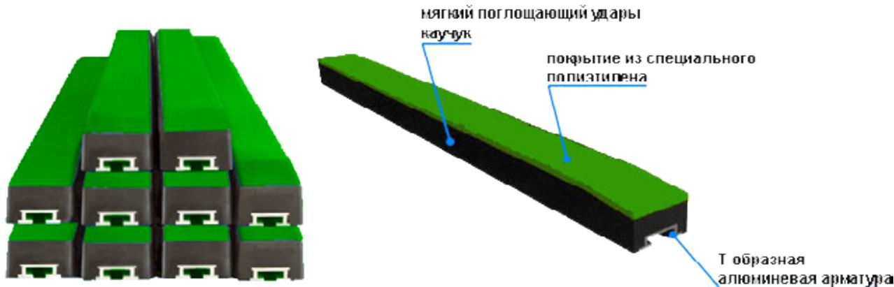
Высокомолекулярный полиэтилен выдерживает температуру до 85°C. В связи с этим необходимо выдержать расстояние в 20 мм между лентой и горизонтально расположеными балками и 10 мм между лентой и наклонными балками. Важно, чтобы транспортируемый материал не попадал в область между лентой и балками. Для этого нужно, чтобы края ленты немного перекрывали крайние балки или совпадали с ними.
