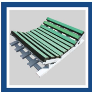
Демпферная станция предназначена для поглощения ударной силы падающего материала, эффективной защиты конвейерной ленты от пробоев и продольных порезов. Устанавливается в месте загрузки перемещаемых материалов. Состоит амортизирующая станция из мощной металлической конструкции (приёмного стола) и демпферных балок в комплекте с Т-образными болтами.
